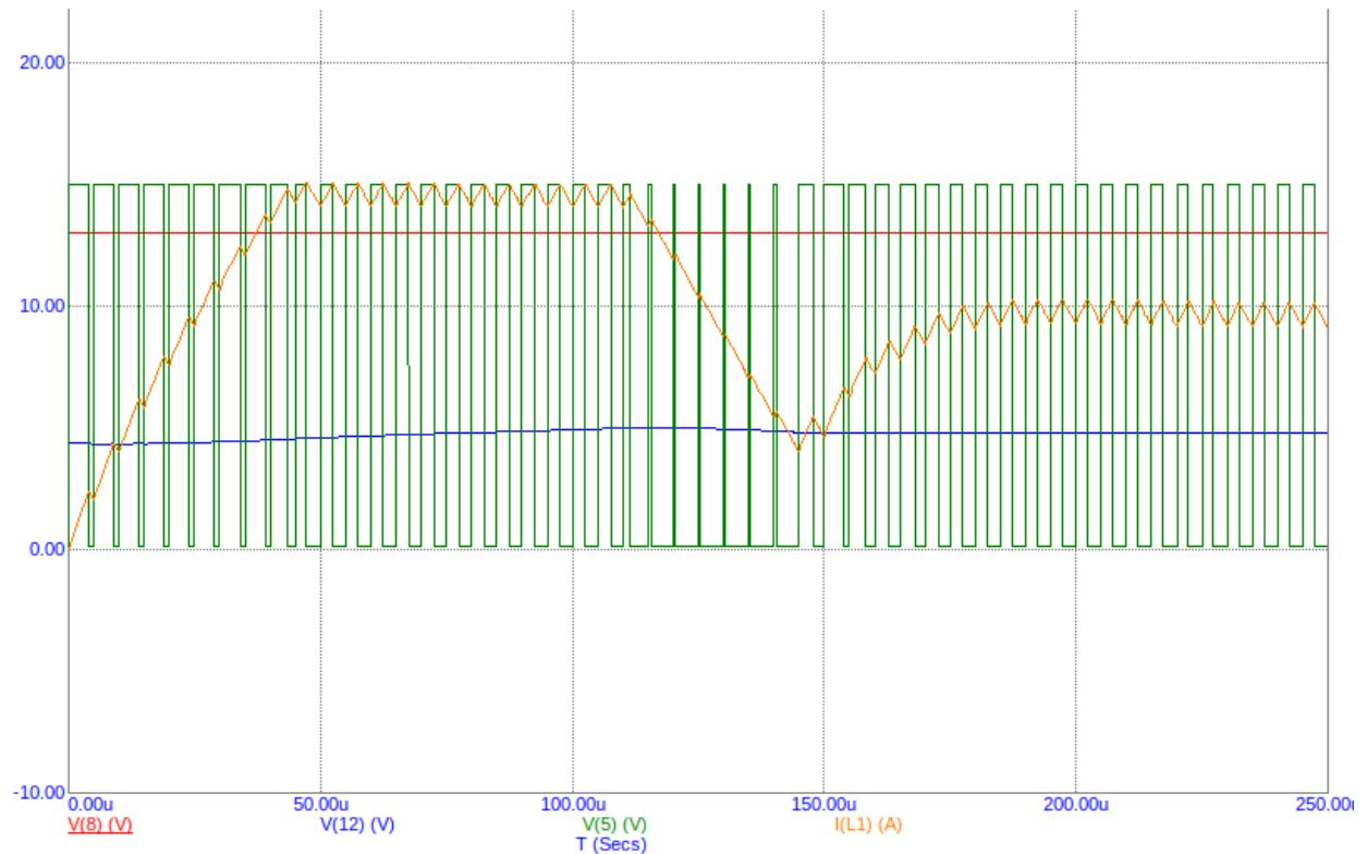
Временные диаграммы сигналов понижающего преобразователя напряжения. Здесь:
