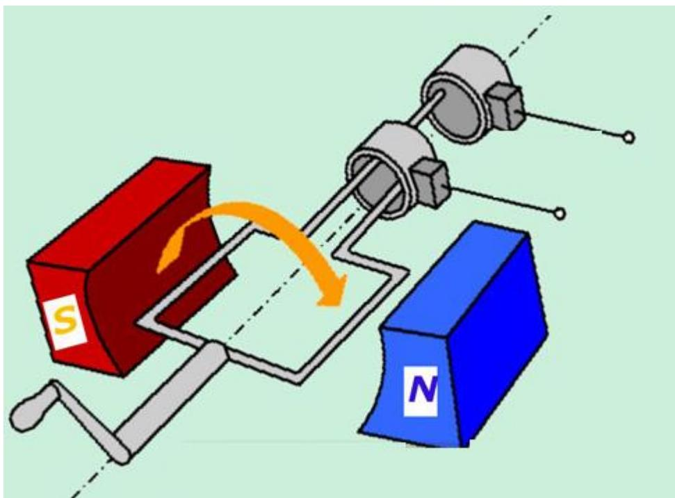
3. Принцип действия генератора переменного тока
