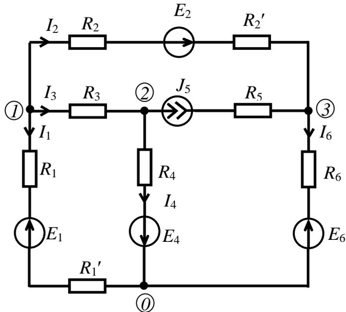
Найти ток в сопротивлении  $R_4$  методом эквивалентного генератора.
