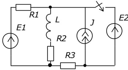
Рассчитать токи после коммутации классическим и операторным методами, построить их графики
