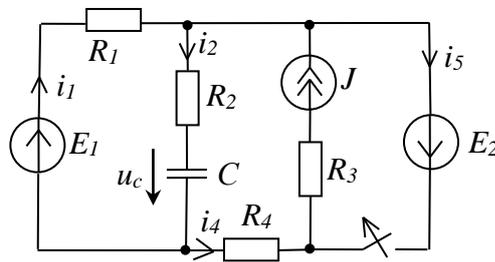
Получить выражения для передаточной функции, переходной и импульсной характеристики, построить их графики. Построить реакцию цепи на прямоугольный импульс с заданными параметрами.
