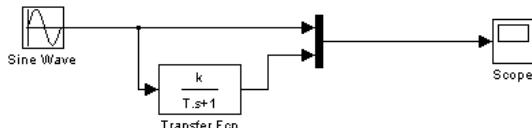
При моделировании частоту генератора гармонического сигнала менять в диапазоне от 1 до 100 рад/с.
