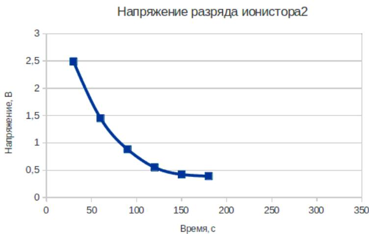
2. По графику определите постоянную времени разряда ионистора (в секундах)
