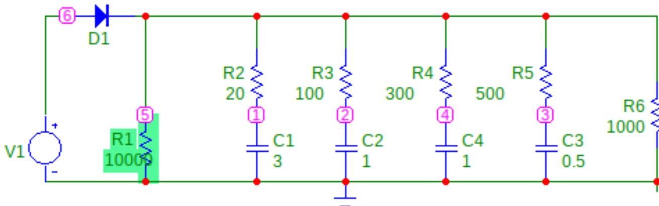
**Установите параметры анализа** модели ионистора. Первым должны воспроизводиться прямоугольные импульсы генератора V1 (на рис. 1 — точка 6 относительно «земли»), затем по порядку — напряжения на каждом конденсаторе C1 - C4, последним — напряжение на нагрузке R6. Подберите разные цвета для графиков. Если у вас контрольные точки размещены по-другому — измените последовательность анализируемых напряжений. Вставьте в файл «ЛР5фамилиягруппа.docx» параметры анализа.
