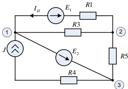
4. Найти ток, протекающей в схеме, представленной на следующем рисунке. Вольтамперная характеристика нелинейного элемента и параметры элементов схемы известны.
