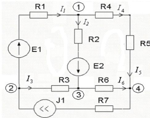
3. Для схемы, представленной на следующем рисунке, методом эквивалентного генератора найти токи через ветвь с сопротивлением  $R_1$ . Параметры элементов схемы известны.
