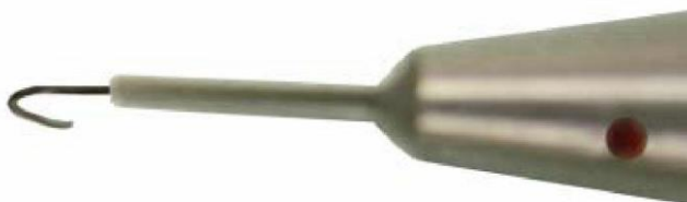
Рис. 9. Установка заготовки в капилляр, отмеченный красной точкой
