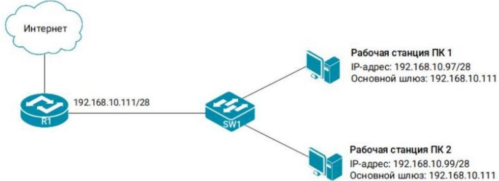
2. На рисунке показана схема сети. Рабочая станция ПК 2 может обмениваться данными с ПК 4, но при этом соединение с ПК 1 отсутствует. Укажите причину проблемы.
