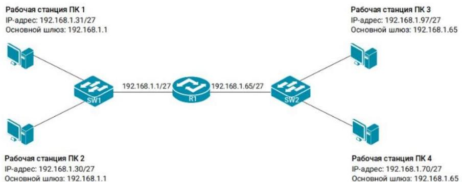
3. На рисунке показана схема сети. Рабочая станция ПК 4 может обмениваться данными с рабочей станцией ПК 2, но при этом соединение с ПК 3 отсутствует. Укажите причину проблемы.
