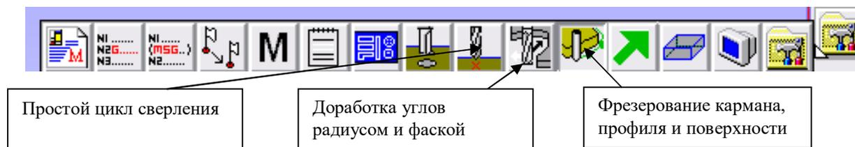
Рисунок 2.24 – Основная линейка команд для формирования операций обработки
