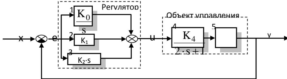
Структура замкнутой САУ представлена на рисунке. Требуется определить передаточные функции регулятора, объекта, разомкнутой системы, замкнутой системы и характеристические выражения.
