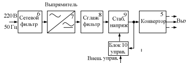
Рис. 4.3. Бестрансформаторный источник питания (2-й вариант)
