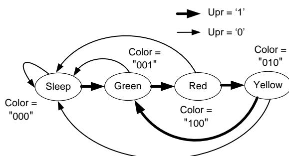
11. Составить по заданной диаграмме состояний описание на языке VHDL **архитектуры** цифрового автомата, управляющего сигналами светофора, с тактовым сигналом *clk*, выходным трехразрядным сигналом *Color*, входным логическим сигналом включения/выключения регулируемого режима работы *Control* и входным логическим сигналом *clk\_1\_Hz* (мейндр частотой 1 Гц) для выдачи мигающих сигналов в режимах ...\_Pulse.
