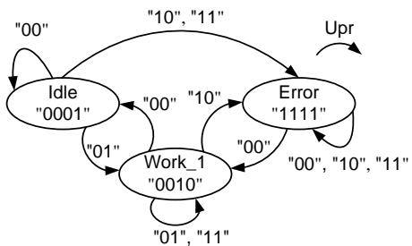
9. Составить описание на языке VHDL **архитектуры** цифрового автомата с тактовым сигналом *clk*, входным двухразрядным логическим сигналом *Upr*, выходным трехразрядным сигналом *Data\_out* и заданной диаграммой состояний.
