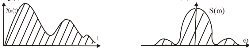
Рис. 1. Непрерывный сигнал и соответствующий ему спектр
