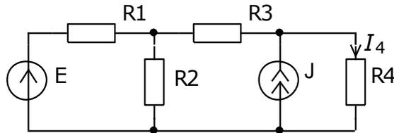
Составить систему уравнений по законам Кирхгофа для определения токов в ветвях схемы: для мгновенных значений и в установившемся режиме. Рассчитать токи.
