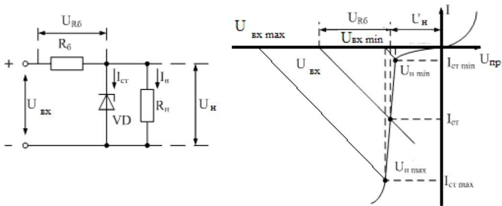
2. Рассчитайте и введите значение коэффициента стабилизации  $K_{\text{ст}}$ , если  $U_{\text{вх max}} = 13,2$ ,  $U_{\text{вх min}} = 6,2$ ,  $U_H \text{ max} = 5,1$ ,  $U_H \text{ min} = 4,9$
