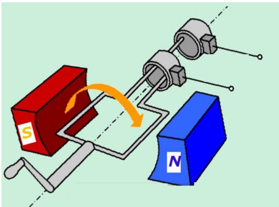
3. Принцип действия генератора переменного тока
