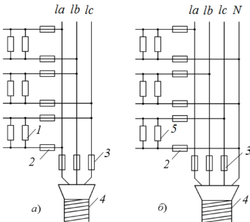
4. На рисунке изображены схемы подключения нагрузок к трехфазной сети. Здесь 1,5 - нагрузки, 2,3 - предохранители, 4 - силовой кабель
