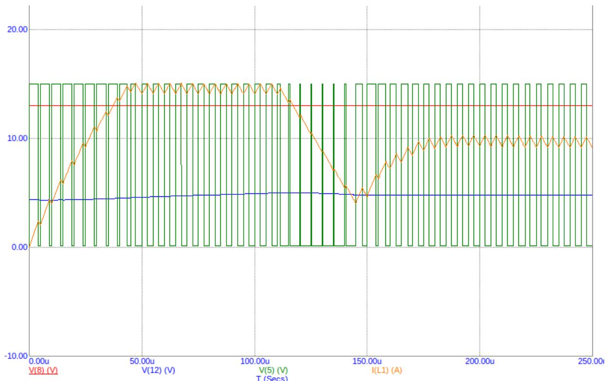
Временные диаграммы сигналов понижающего преобразователя напряжения. Здесь:
