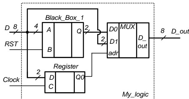
38. Составить описание на языке VHDL **архитектуры** цифрового устройства с помощью структурного стиля программирования. При подключении компонентов в содержательной части архитектуры применить и позиционное, и поименованное подключение портов. При запрещенных идентификаторах заменить их на разрешенные.
