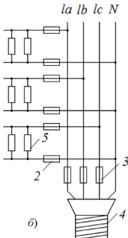
4. На рисунке изображены схемы подключения нагрузок к трехфазной сети. Здесь 1,5 - нагрузки, 2,3 - предохранители, 4 - силовой кабель
