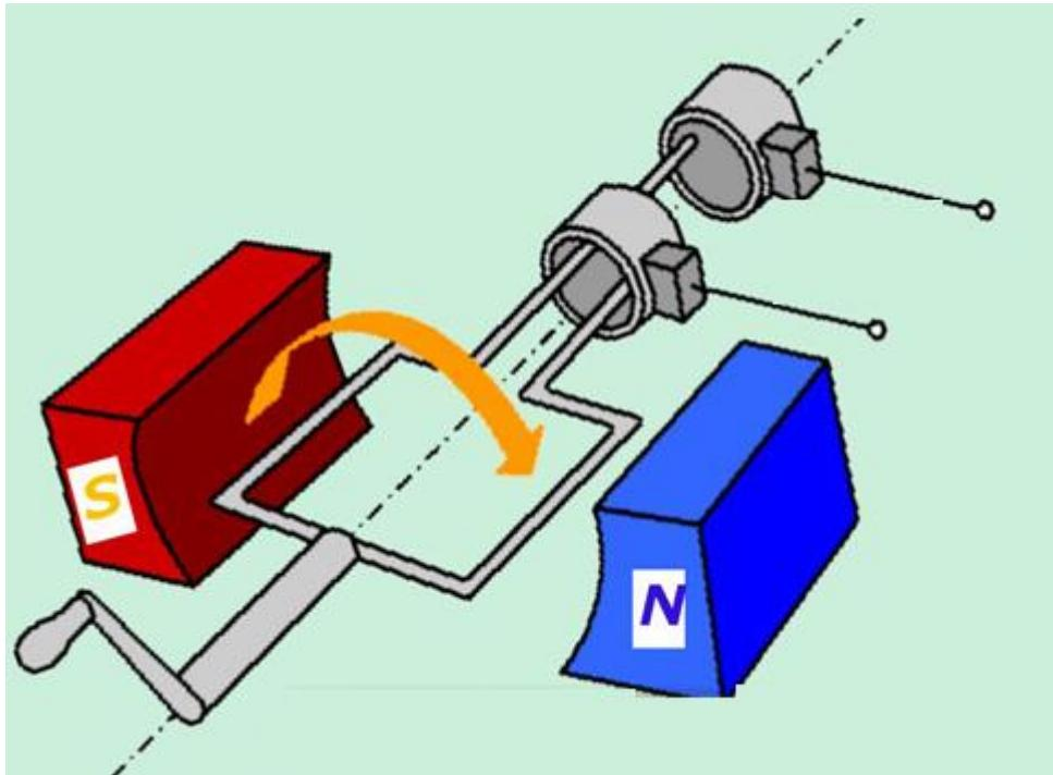
3. Принцип действия генератора переменного тока
