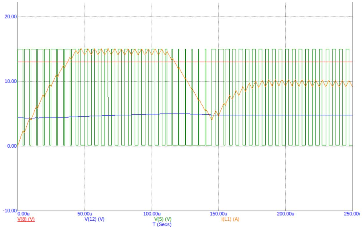
Временные диаграммы сигналов понижающего преобразователя напряжения. Здесь:
