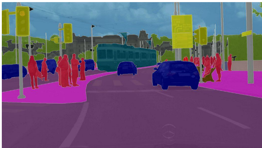
Сегментация изображения дорожной обстановки при помощи сети Unet
