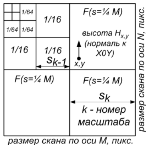
Рис. 17. Иллюстрация разбивки изображения поверхности на сегменты различного размера
